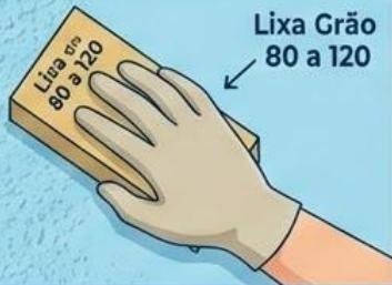
Após **7 a 12 horas de cura**, é possível realizar acabamento com **lixar grão 80 a 120**, deixando a superfície lisa novamente.
